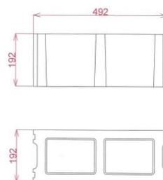
Un bancale contiene 7,0 m<sup>2</sup> e numero 70 blocchi di cui: n° 56 con due teste portamalta, n° 14 con due teste lisce + foro per mezzzeria.
