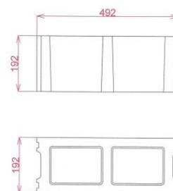
Un bancale contiene 7,0 m<sup>2</sup> e numero 70 blocchi di cui: n° 56 con due teste portamalta, n° 14 con due teste lisce + foro per mezzeria.
