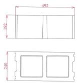
Un bancale contiene 5,6 m² e numero 56 blocchi di cui: n° 42 con due teste portamalta, n° 14 con due teste lisce + foro per mezzeria.
