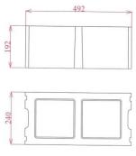
Un bancale contiene 5,6 m² e numero 56 blocchi di cui: n° 42 con due teste portamalta, n° 14 con due teste lisce + foro per mezzeria.
