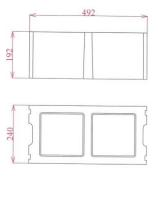
Un bancale contiene 5,6 m² e numero 56 blocchi di cui: n° 42 con due teste portamalta, n° 14 con due teste lisce + foro per mezzeria.
